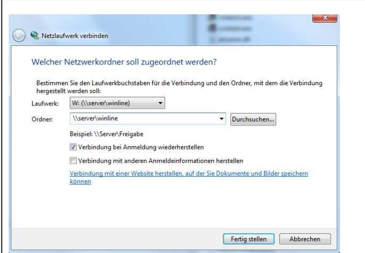
Einrichtung einer fixen Laufwerkszuordnung am Client zur Freigabe am Server.
